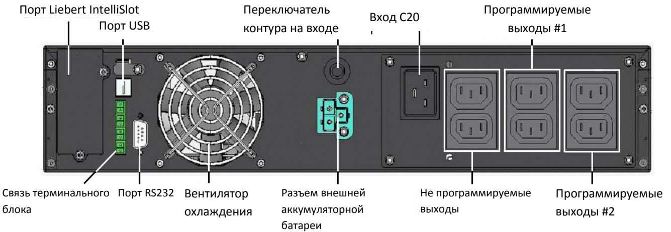
Рис. 4 Задние компоненты, модели Liebert GXT4 230V 2000VA
