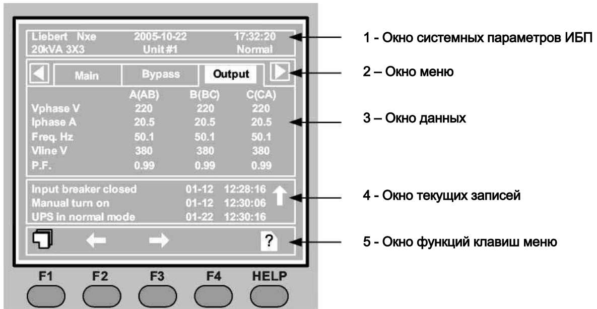
Рисунок 28 - Графические окна ЖК-дисплея и клавиши
