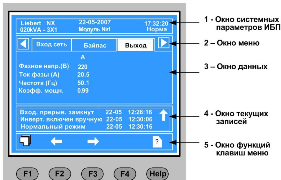
Рисунок 32 - Графические окна ЖК-дисплея
